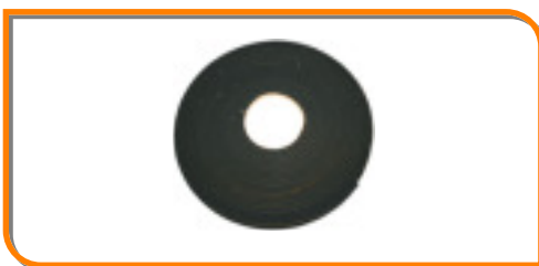
Mousse adhésive se place sur la vitre pour empêcher le débordement de colle sur la cabine ép. 5 mm L 10 m
